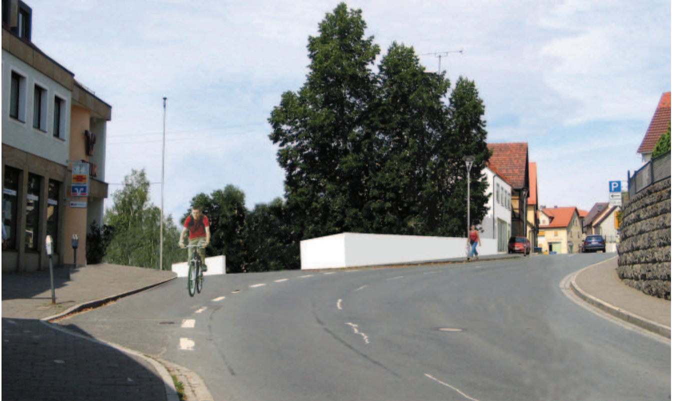
Bildmontage: Eine Stützmauer fängt das geneigte Gelände ab und bildet eine Raumkante.
