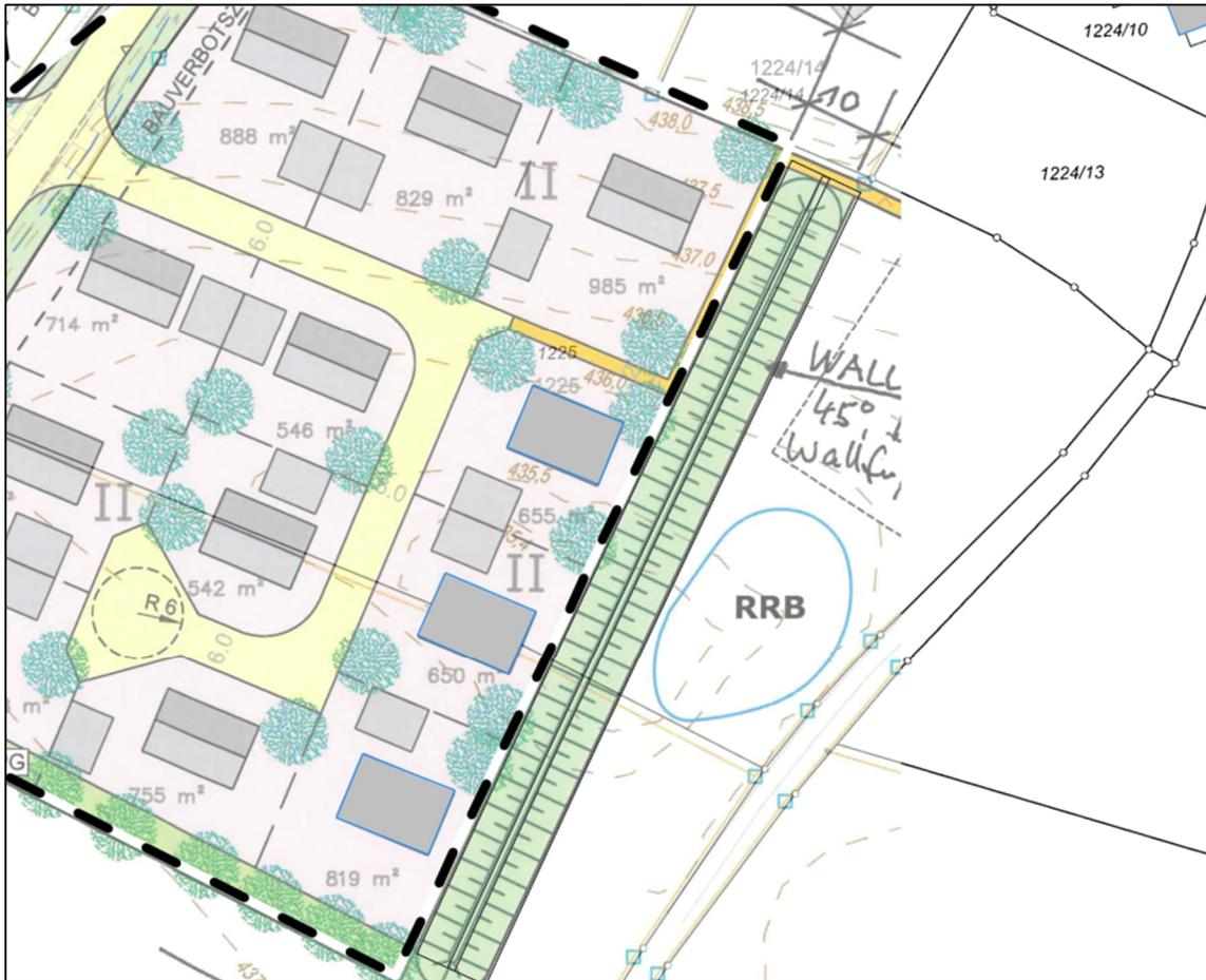
Abbildung 5: Lageplan mit Darstellung des zu realisierenden Lärmschutzwalls /13/
