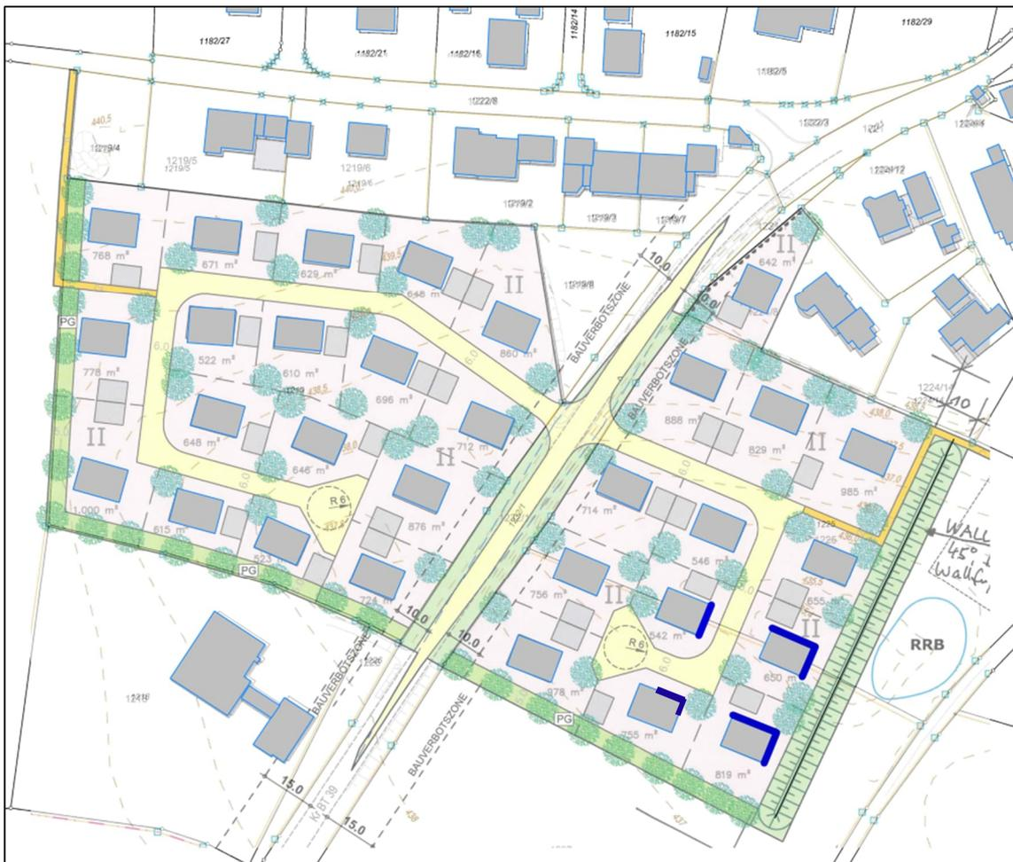
Abbildung 6: Lageplan mit Darstellung der Fassadenbereiche an denen Schallschutzmaßnahmen erforderlich sind
